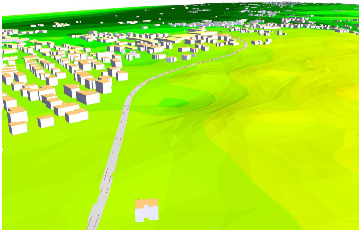
Figura 10. Esempio di modello digitale del suolo con edifici inseriti per la S.P. 28 “Reggio Emilia - Montecchio - Ponte Enza”.
