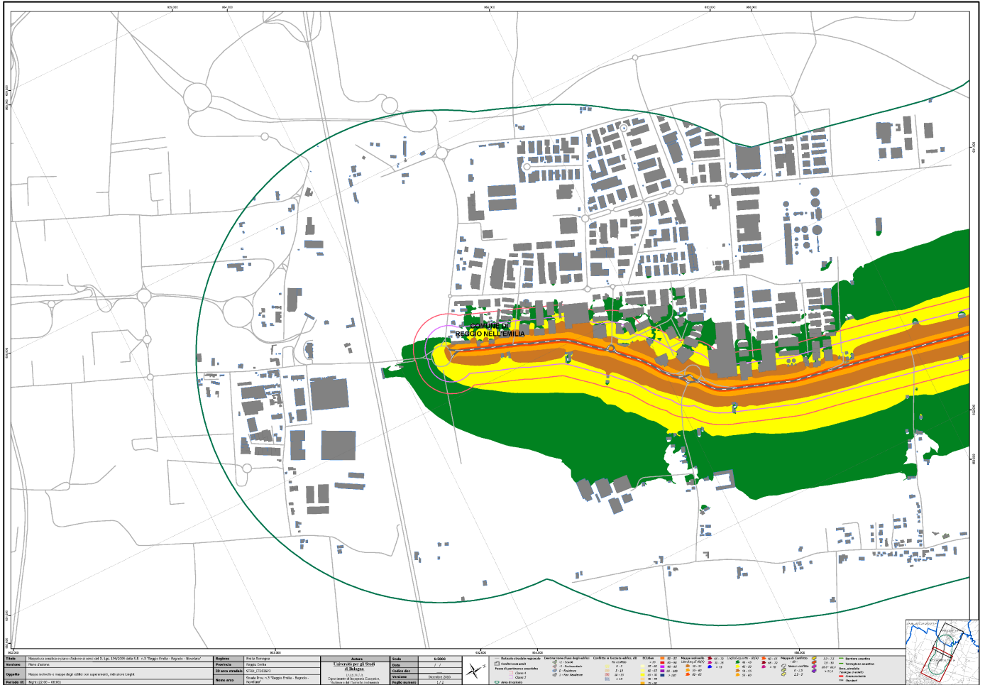
Figura 6. S.P. 3 "Reggio Emilia - Bagnolo – Novellara". Mappa isolivello e mappa di conflitto per singoli edifici in termini di L_{night} in dB(A) dopo gli interventi pianificati (cfr.4.4).
