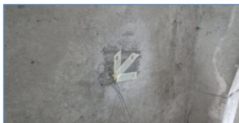
Posizionamento Strain-Gauges
