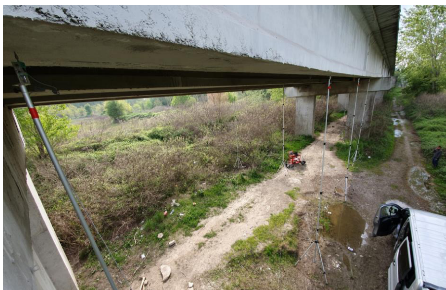
Figura 10: Disposizione dei trasduttori nel ponte lato Guastalla (RE) durante le prove di carico
