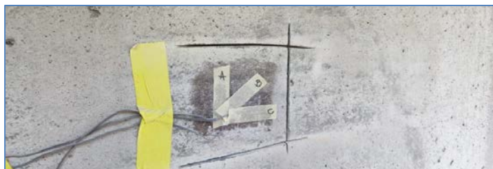
Posizionamento Strain-Gauges
