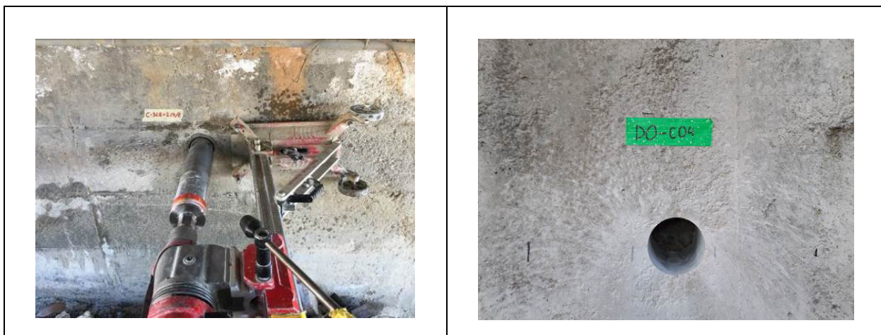
Figura 4: Esempio di macchina di perforazione e foro dopo il sondaggio
