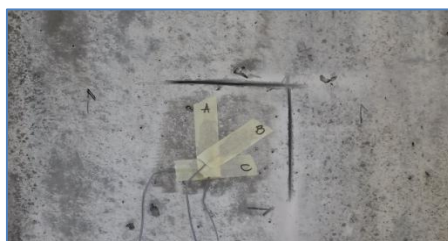
Posizionamento Strain-Gauges
