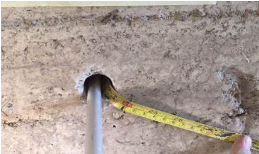
Figura 8: Esempio tipo di microcarotaggio con endoscopia
