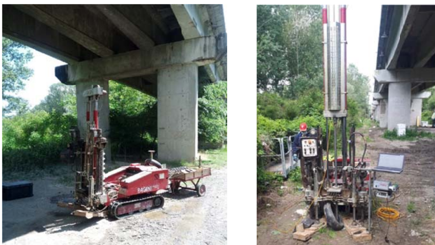
Figura 5.7: – foto delle prove penetrometriche eseguite nel giugno 2021
