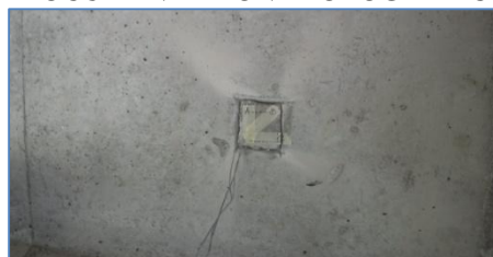
Posizionamento Strain-Gauges
