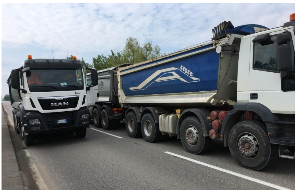
Figura 26: Posizionamento dei mezzi in accordo alla seconda configurazione di carico lato Guastalla
