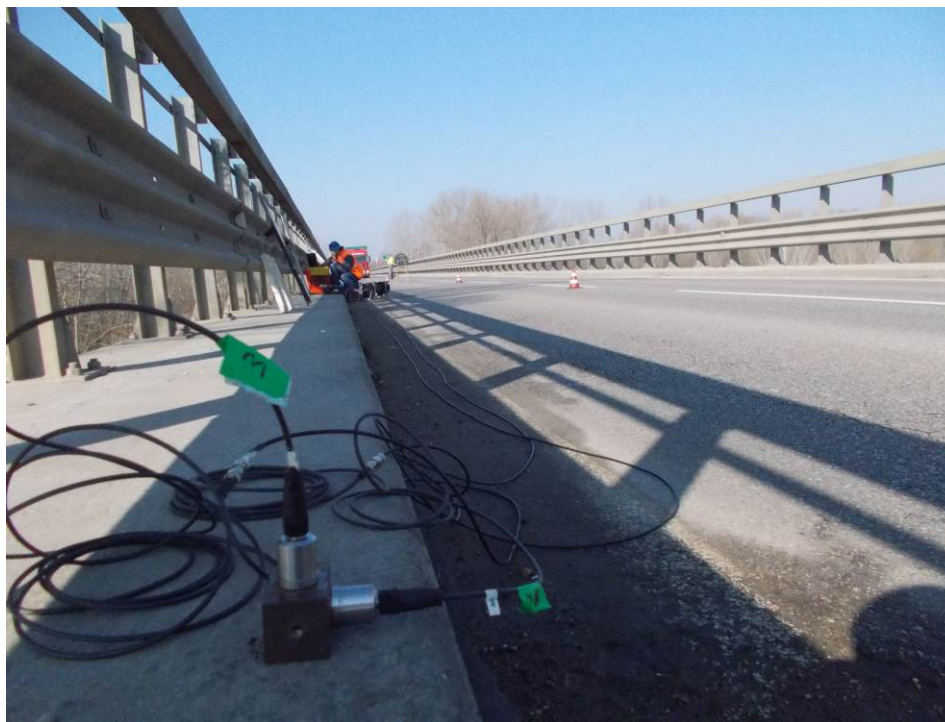
Foto 11: Particolare degli accelerometri 3 e 4 durante le prove
