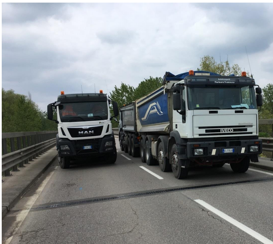
Figura 8: Posizionamento dei camion sulla sede stradale lato Guastalla (RE).
