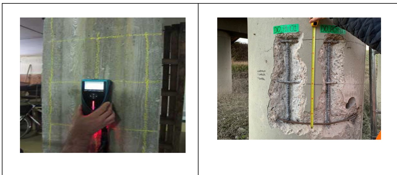
Figura 9: prova pacometrica a sx e scarifica di un elemento strutturale a dx
