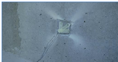
Posizionamento Strain-Gauges
