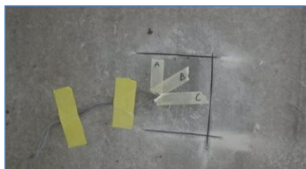
Posizionamento Strain-Gauges
