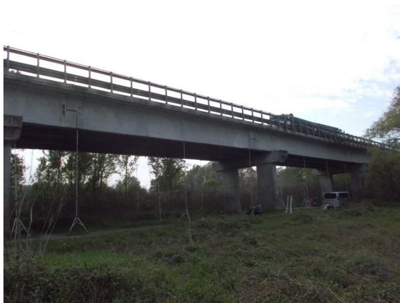
Figura 29: Posizionamento dei mezzi in accordo alla terza configurazione di carico lato Guastalla
