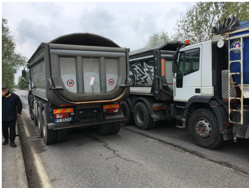
Figura 18: Posizionamento dei mezzi in accordo alla seconda configurazione di carico lato Dosolo
