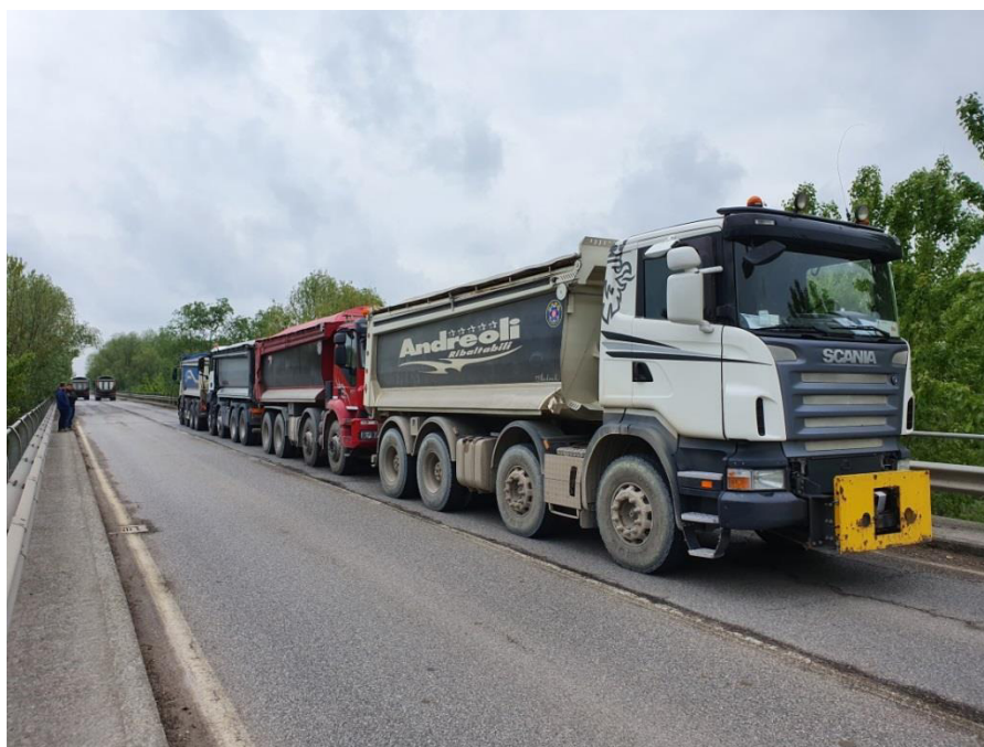
Figura 15: Posizionamento dei mezzi in accordo alla prima configurazione di carico lato Dosolo
