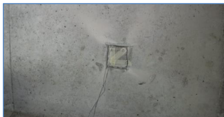
Posizionamento Strain-Gauges
