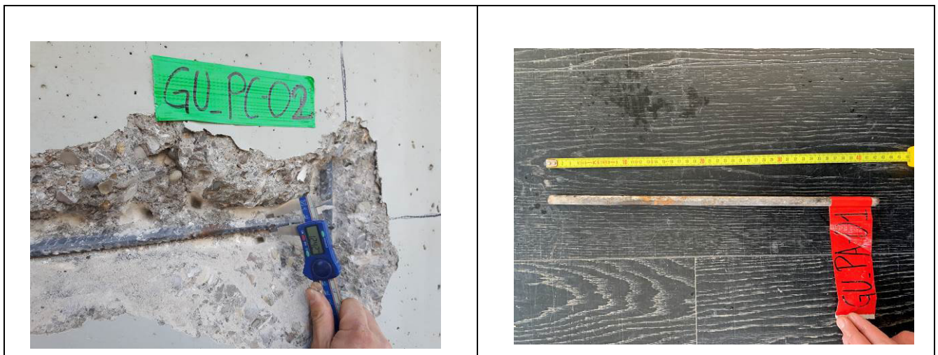
Figura 7: prelievo campioni di acciaio
