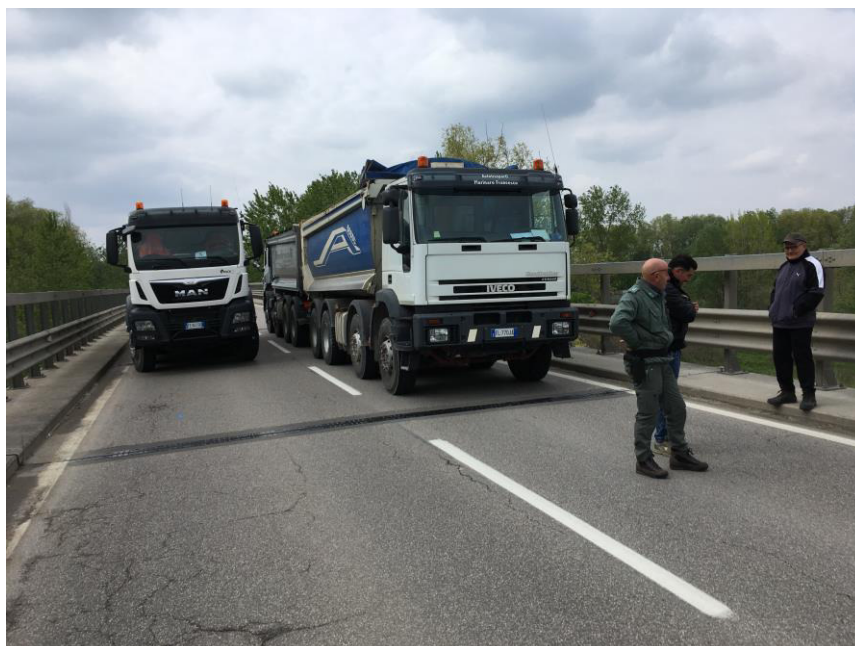
Figura 23: Posizionamento dei mezzi in accordo alla prima configurazione di carico lato Guastalla
