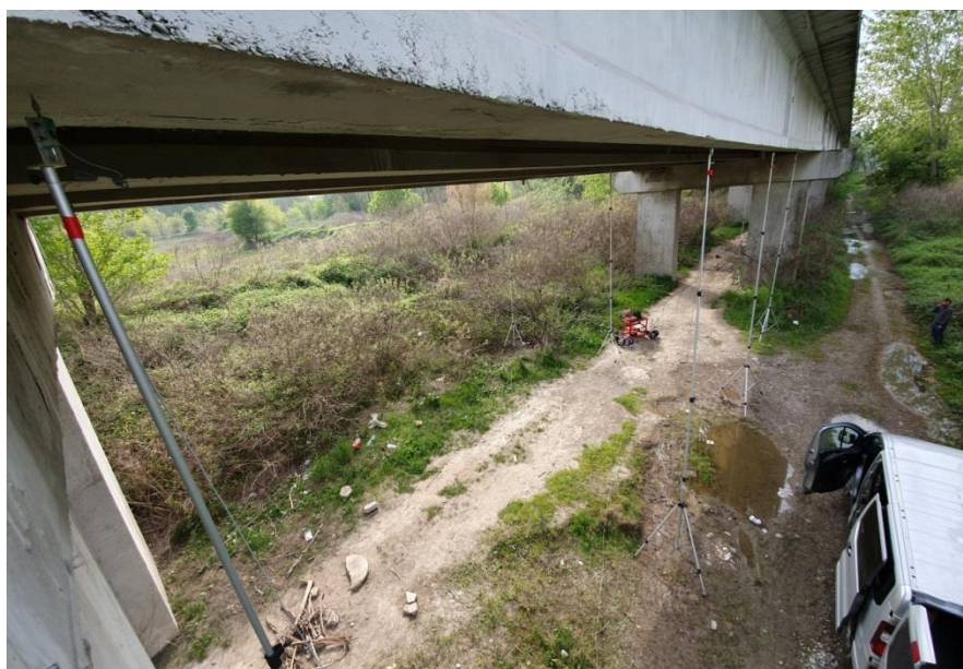
Figura 21: Disposizione dei trasduttori per la prova nel ponte lato Guastalla (RE)
