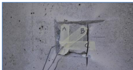
Posizionamento Strain-Gauges
