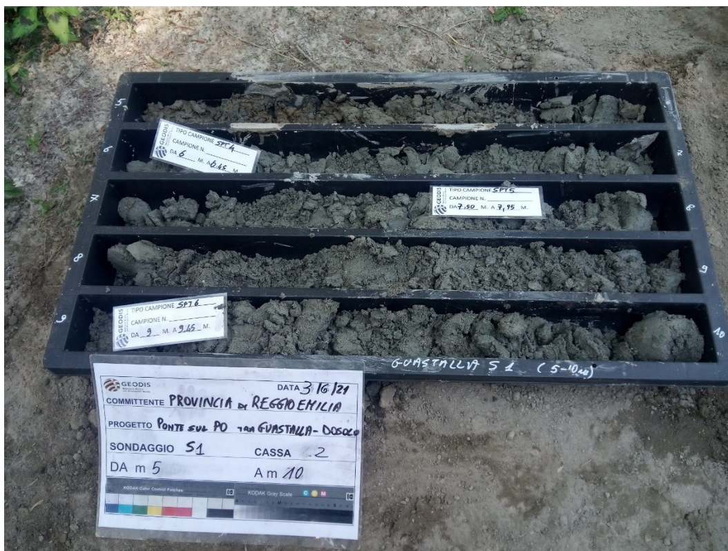
Fig. 7 - Sondaggio S1 cassa 2 (5,00-10,00m)
