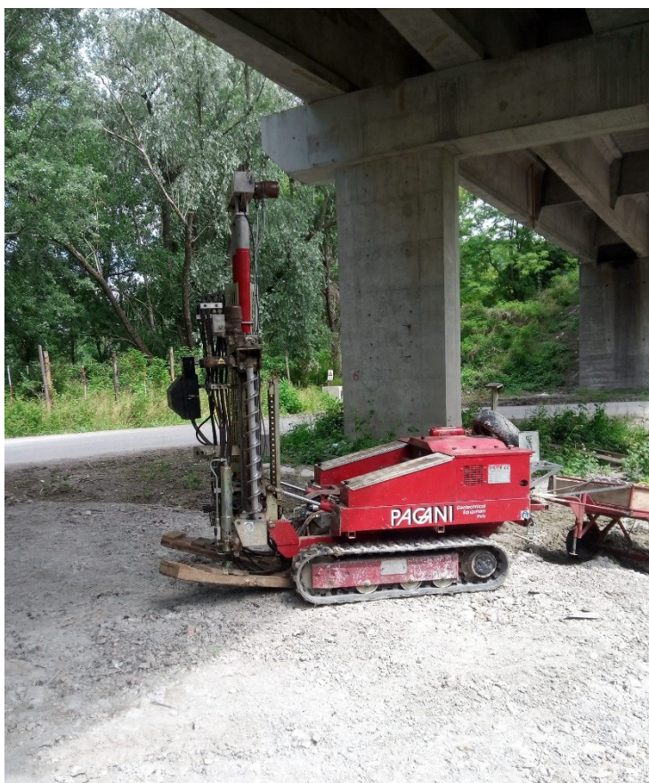
Fig. 3 - Esecuzione prova penetrometrica statica CPTU3
