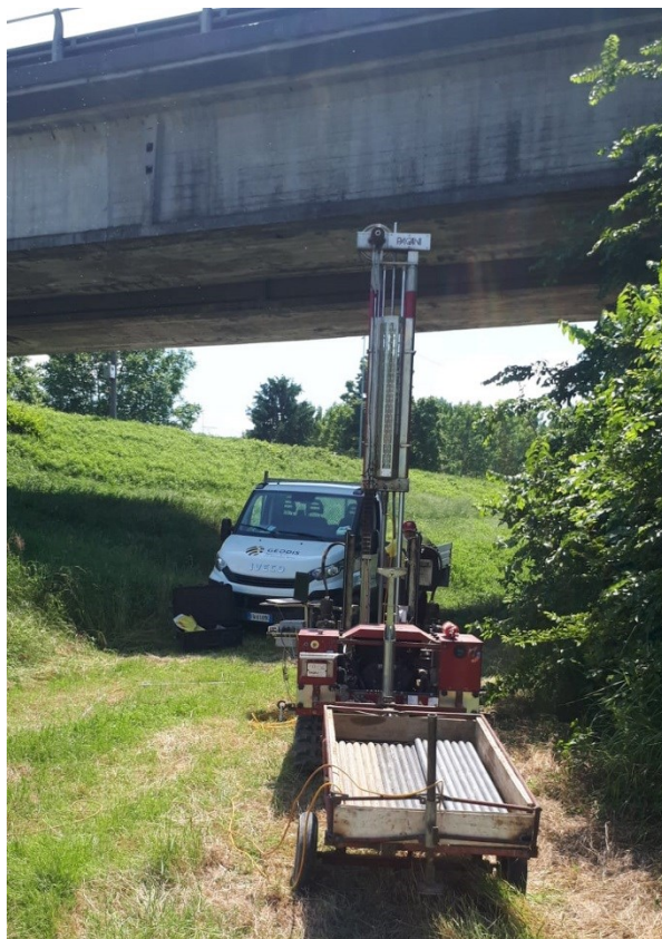
Fig. 1 - Esecuzione prova penetrometrica statica CPTU1
