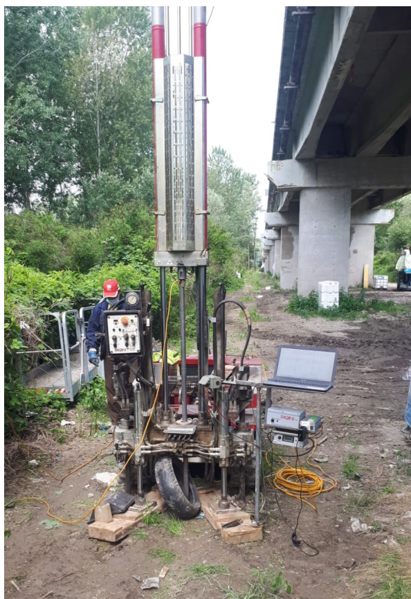
Fig. 2 - Esecuzione prova penetrometrica statica CPTU2
