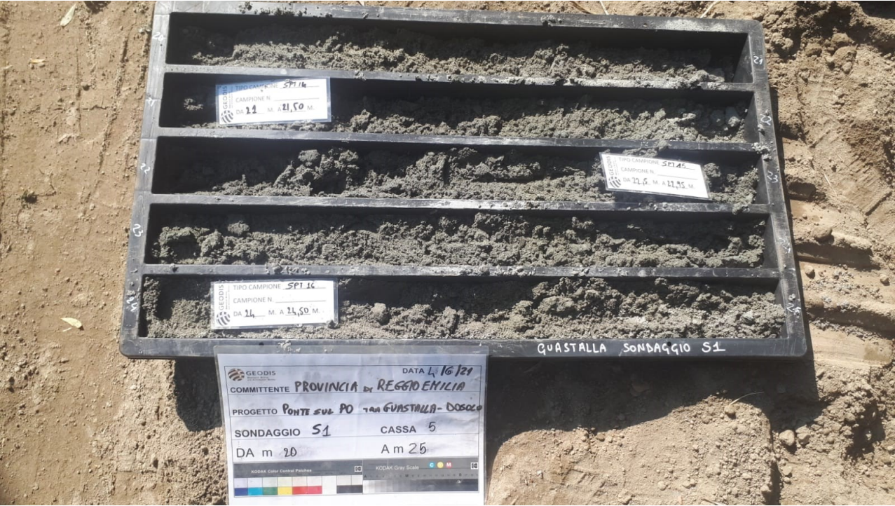
Fig. 10 - Sondaggio S1 cassa 5 (20,00-25,00 m)
