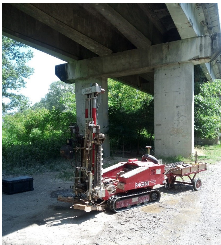
Fig. 4 - Esecuzione prova penetrometrica statica CPTU4
