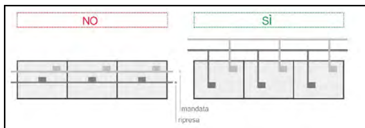
Figura 53: accorgimenti costruttivi (coretto posizionamento delle canalizzazioni tra aule distinte)
