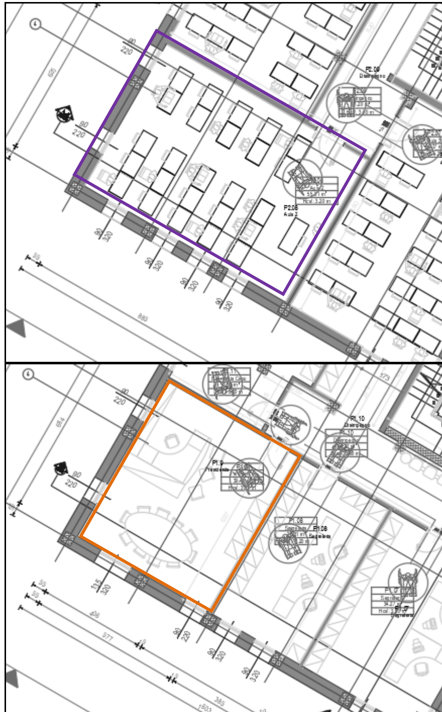
Figura 5: elaborati progettuali (analisi previsionale isolamento per via aerea, laboratori sovrapposti)
